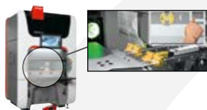
Bystronic Xpert 40. Abkantlänge: 1.030 mm, Presskraft: 400 kN (40 to)
